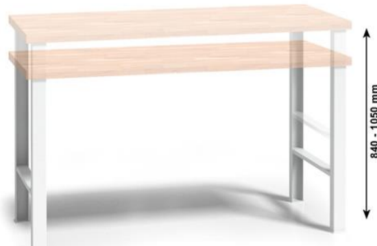
Fußgestell höhenverstellbar, Werkbankhöhe 840 bis 1000 mm. Einstellbar in 50-mm-Schritten
