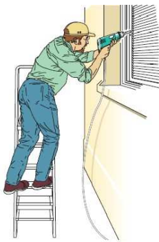
Falsch – Treppe seitlich zur Arbeitsposition ausgerichtet
