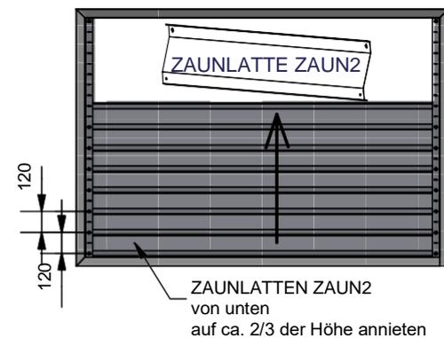
3. Das Zaunfeld vom Rahmen demontieren, indem die selbstbohrenden Schrauben entfernt werden, und dann die restlichen Zaunlatten hinzufügen
