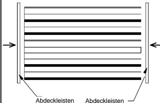
5. Das komplette Zaunfeld wieder in den Rahmen einsetzen und mit selbstbohrenden Schrauben sichern
