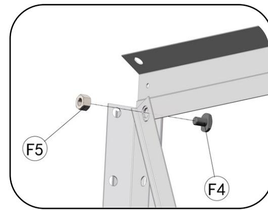
Entfernen Sie zuerst die Mutter und installieren Sie dann den **A28**.
