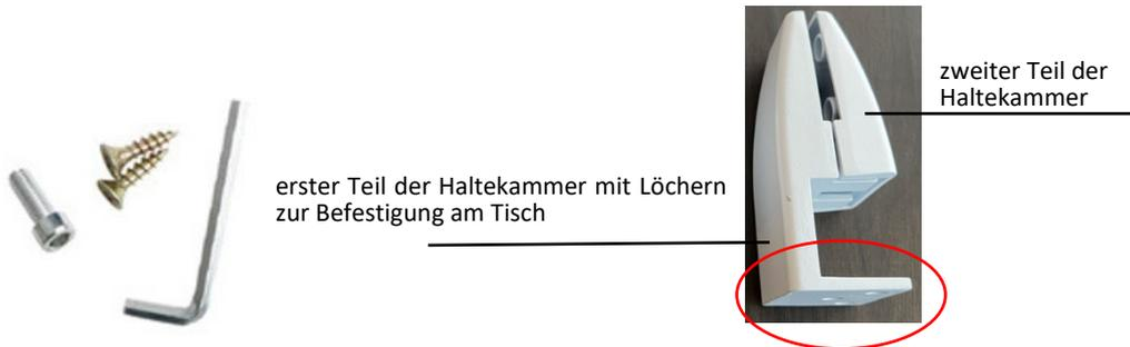
1. Die Haltekammer besteht aus zwei Teilen, wobei ein Teil auch an der Unterseite Löcher zur Befestigung der Tischplatte mit Schrauben hat. Montieren (bohren) Sie zuerst an der Tischplatte.
