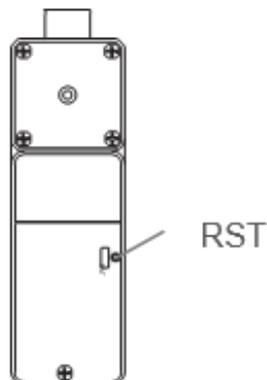
Nehmen Sie die Batterien heraus (eine reicht aus) und stecken Sie die mitgelieferte Stecknadel in das Reset-Loch. Wenn die RST-Taste gedrückt wird, legen Sie die Batterie in das Fach zurück.
