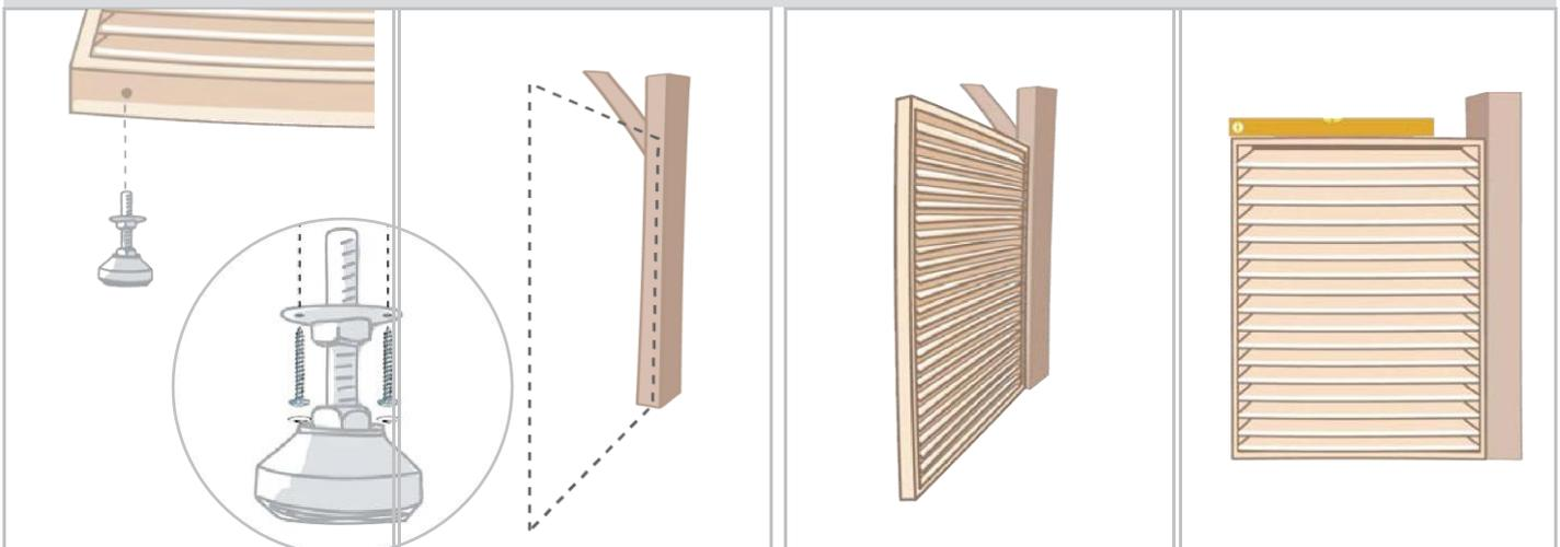
1. Packen Sie das Jalousienpaket aus. Wenn Sie möchten: Stecken Sie die verstellbaren Füße in die beiden Löcher an der Unterseite. Befestigen Sie jedes Bein mit drei Schrauben.
