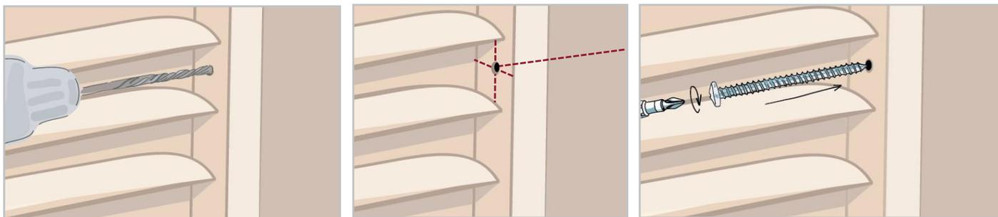
5. An der ersten markierten Stelle ein Loch vorbohren (mit einem kleinen 3-mm-Bohrer), rundum zum Rahmen bohren. Das vorgebohrte Loch führt die Schraube dann in die richtige Richtung.
