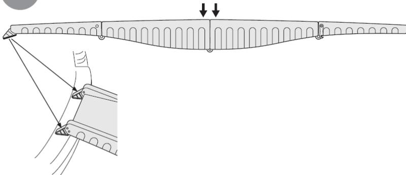
Beide Seiten der Rampe sind mit Aufsitzflächen ausgestattet, um die Gefahr des Ausrutschens zu verringern.
