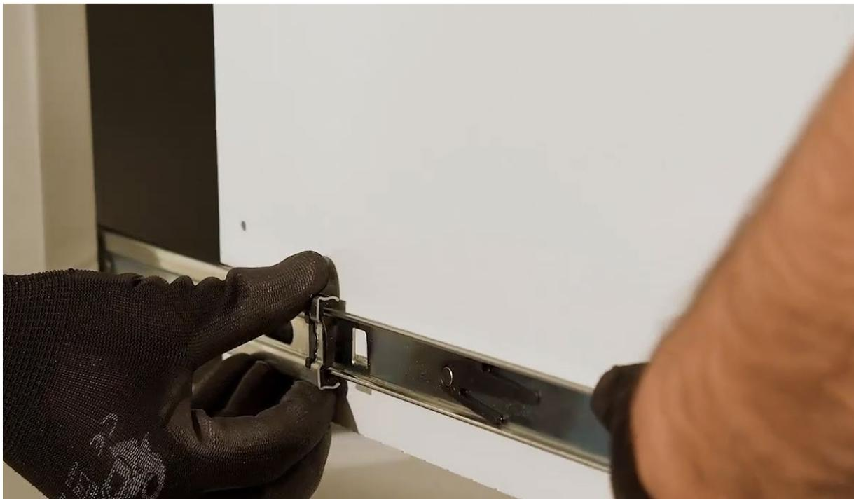
3. An die Schubladenfronten befestigen Sie die Platten C mit 4 Schrauben D.
