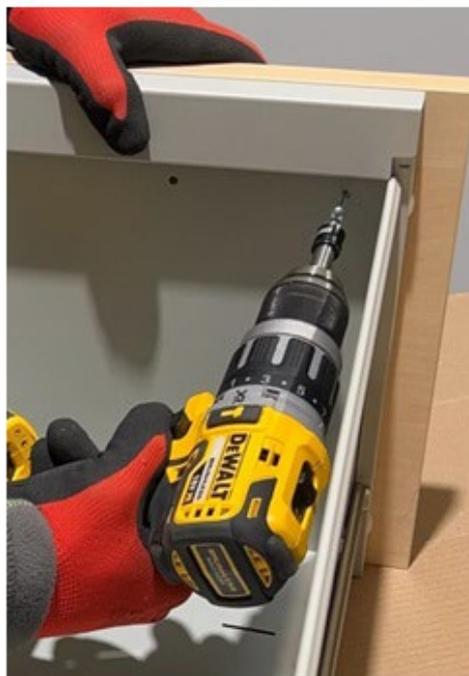
4. An die Schubladenfronten mit Platten befestigen Sie den Handgriff **F** mit zwei Schrauben **E** (von der Innenseite der Schublade).
