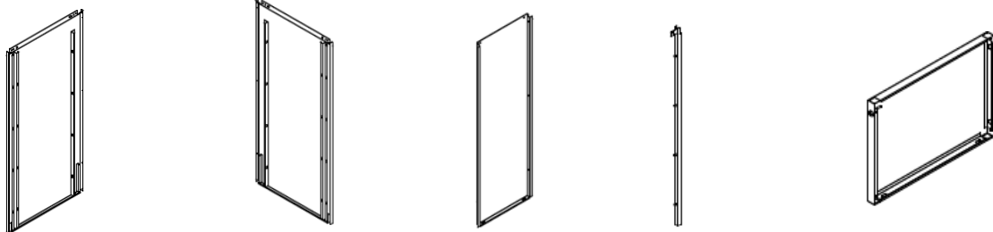
Rechte Seitenwand – 1x Linke Seitenwand – 1x Rücken – 1x Verriegelungsstange – 1x Oberplatte – 1x
