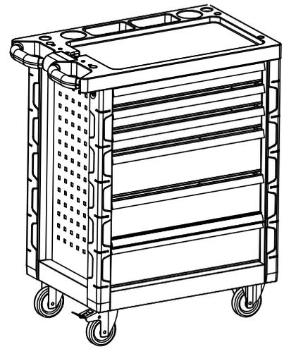
Stellen Sie den Schrank auf den Kopf. Für die Installation des Rades verwenden Sie die M8\*16-Schraube und M8-Dichtung. Schrauben Sie 2 fixen Rollen auf der einen Seite, eine Lenkrolle und eine Bremsrolle auf der anderen Seite des Schrankes an.
