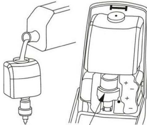
Füllen Sie den Tank mit Seife/Desinfektionsmittel (1 Liter). Nehmen Sie zum Nachfüllen von Seife/Desinfektionsmittel immer den Tank aus dem Spender.
