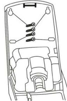
Schrauben Sie die oberen 2 Schrauben zur Hälfte ein, hängen Sie den Spender auf und ziehen Sie alle 4 Schrauben fest.
