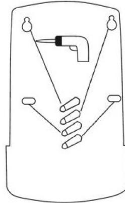
Bohren Sie Löcher und stecken Sie Dübel in die Löcher.
