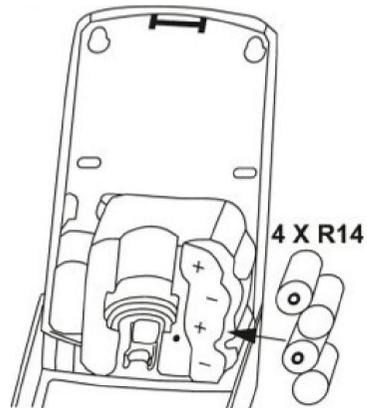
Öffnen Sie die Abdeckung des Batteriefachs, legen Sie die Batterien ein und klappen Sie die Abdeckung wieder zu.
