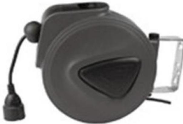
Zum Aufhängen der Trommel einfach die Halterung mit zwei M6-Schrauben in einer Höhe von 80 cm festschrauben. Die empfohlene Länge der Schrauben beträgt mindestens 8cm. Bei der Befestigung empfehlen wir zusätzlich Unterlegscheiben zwischen Schraube und Trommelhalterung zu verwenden.
