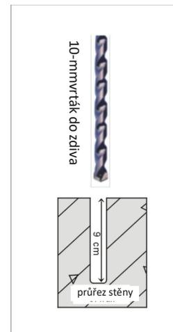
6. Stecken Sie einen  $\phi 10 \times 50$  mm Kunststoffdübel (4 Stück) in jedes der Löcher
