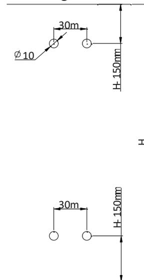
2. Stecken Sie in jedes der Löcher einen  $\phi 10 \times 50$  mm Kunststoffdübel.
