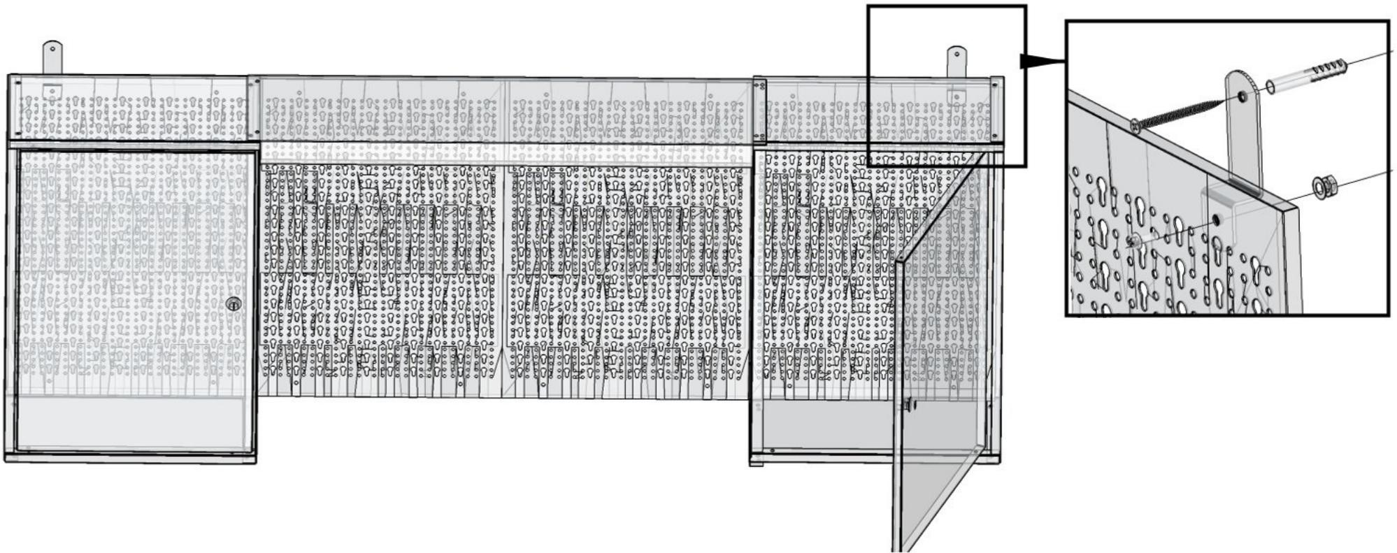
Montieren Sie die Aufhängebügel an der Wand und befestigen Sie sie mit Schrauben und Dübeln, je nach Beschaffenheit der Wand, an der der Schrank befestigt wird, passen Sie die Art und Menge des Befestigungsmaterials an (Dübel, Schrauben, Anker...)
