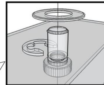
Stecken Sie den Stift in das Loch und sichern Sie ihn mit dem Sicherungsring, bringen Sie die Unterlegscheibe an.
