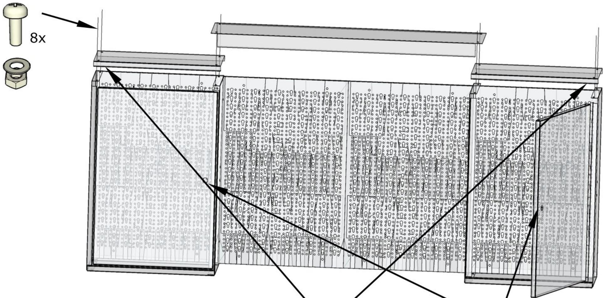
Setzen Sie die Tür auf den unteren Stift, decken Sie sie von oben mit dem Teil ab, das den Stift trägt. Schrauben Sie den oberen Teil einschließlich der Leuchtstofflampenabdeckung an. Wiederholen Sie den Vorgang mit dem anderen Schrank. Setzen Sie das Schloss wie abgebildet in das Loch in der Tür ein und sichern Sie es mit einem flexiblen Splint.
