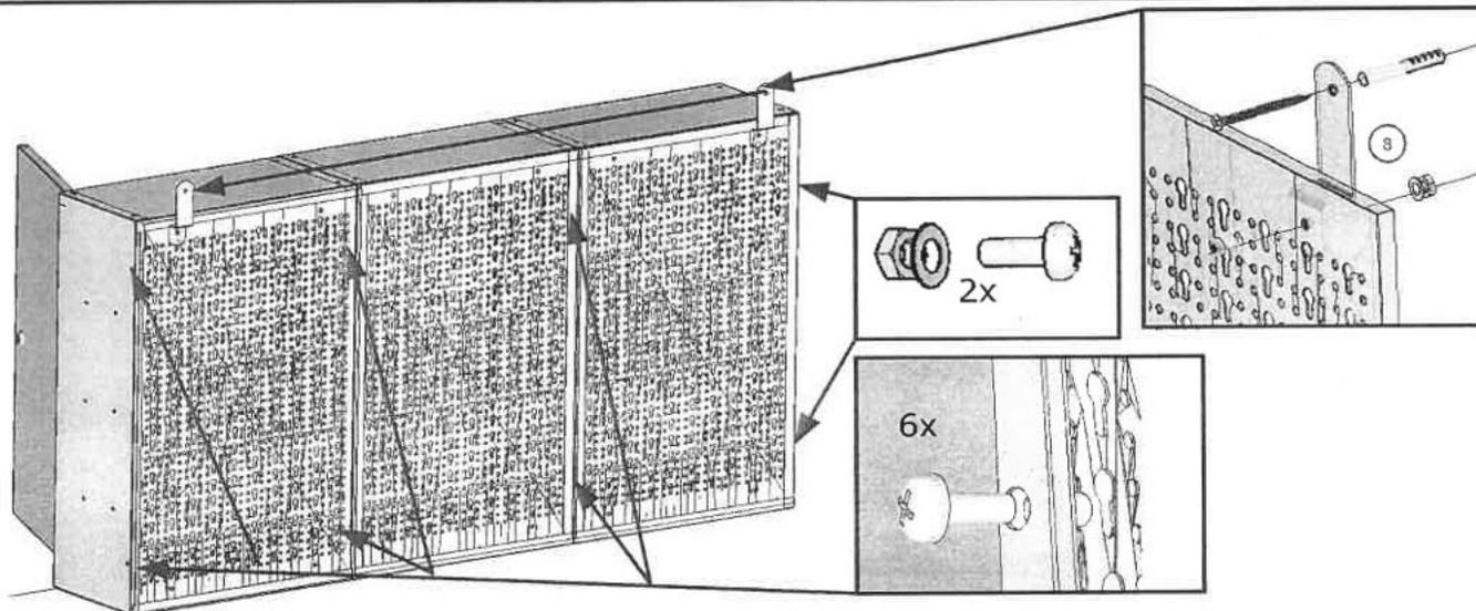
Verbinden Sie die einzelnen Schränke, indem Sie sie wie in Abbildung 3 gezeigt zusammenschrauben und mit dem Teil (8) an der Wand befestigen.
