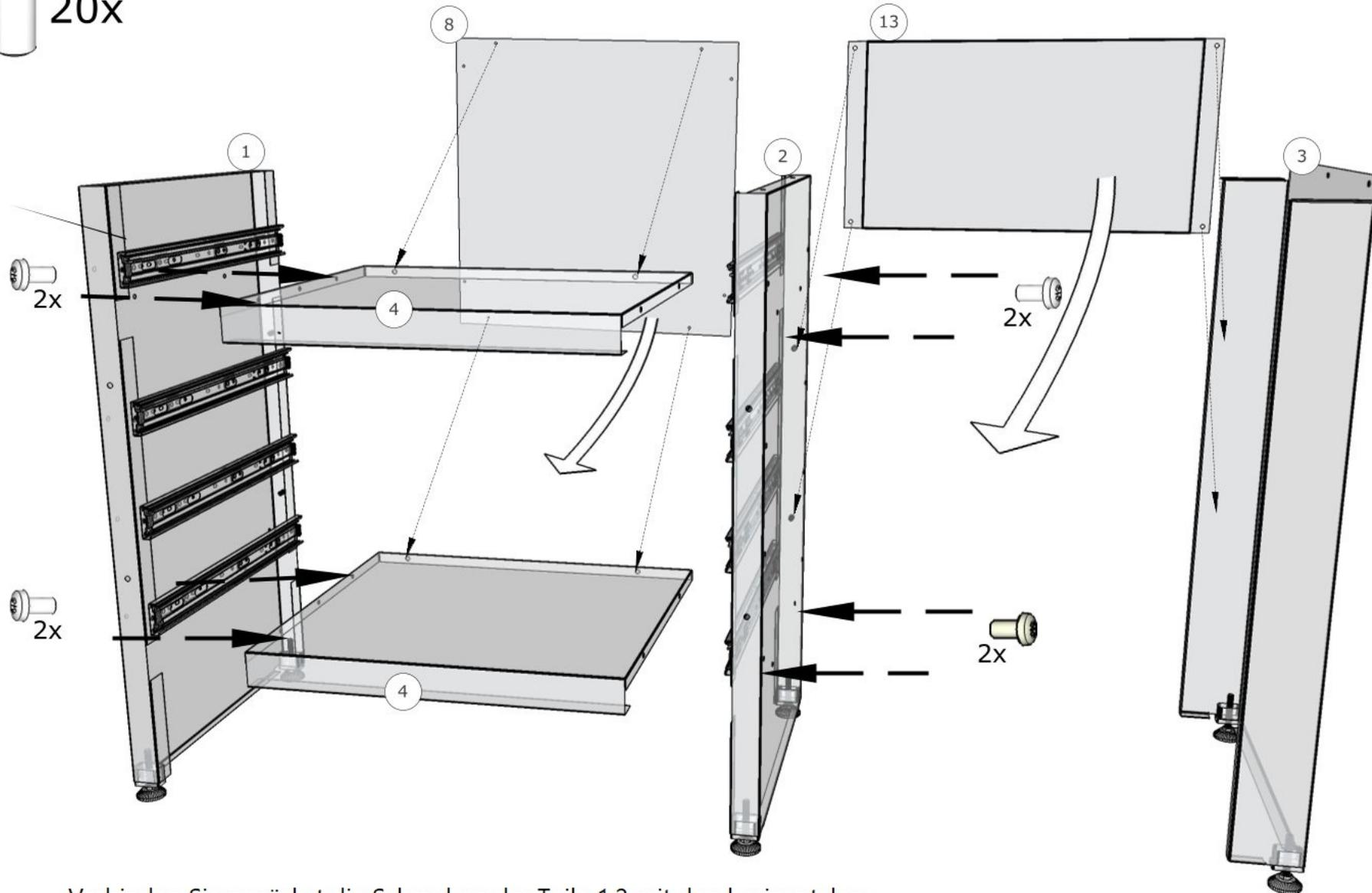
Verbinden Sie zunächst die Schrauben der Teile 1,2 mit den horizontalen Teile 4(2x) einfügen und mit Teilen 13 und 3 verbinden. Schließlich montieren Sie von der Rückseite aus Teil 8, Schrauben (D)8x.
