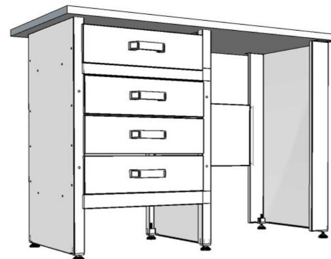
Legen Sie die Tischplatte in der gewählten Position auf die Struktur, markieren Sie die Position der Löcher und bohren vor. Befestigen Sie die Schrauben (Q) mit Sechskant Kopf mit Hilfe eines Seitenschlüssels. Montieren Sie die Schubladen, indem Sie die Führungsteile zusammenfügen und einschieben.
