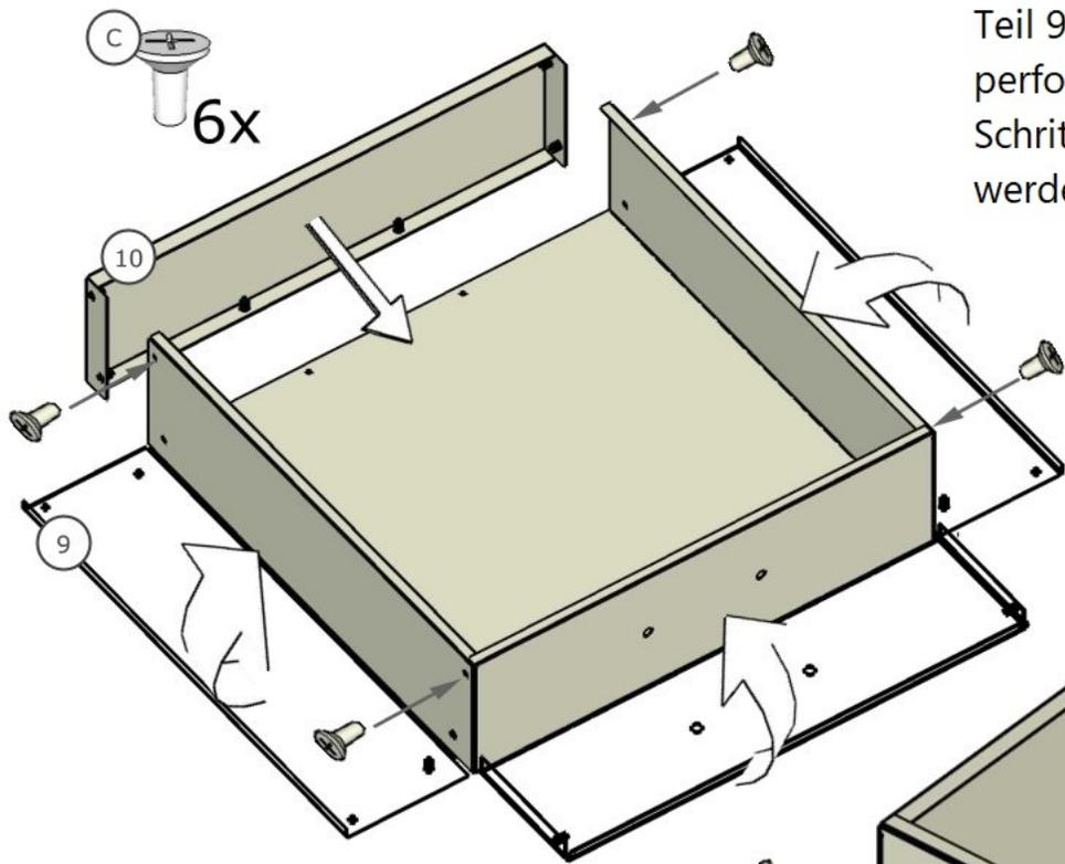
Teil 9 - Schublade: Falten Sie das Stück mit der Hand entlang der perforierten Linie mit den gefalteten Säumen nach innen. Im nächsten Schritt wird die Schublade fertig zusammengesetzt. Auf diese Weise werden Sie 4 Schubladen zusammensetzen.
