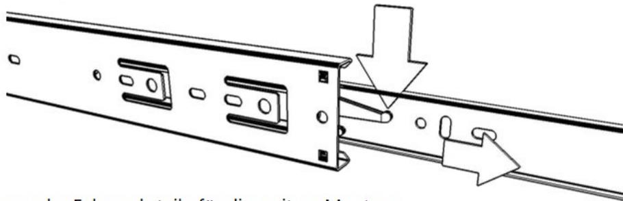
Anordnung der Fahrwerksteile für die weitere Montage
