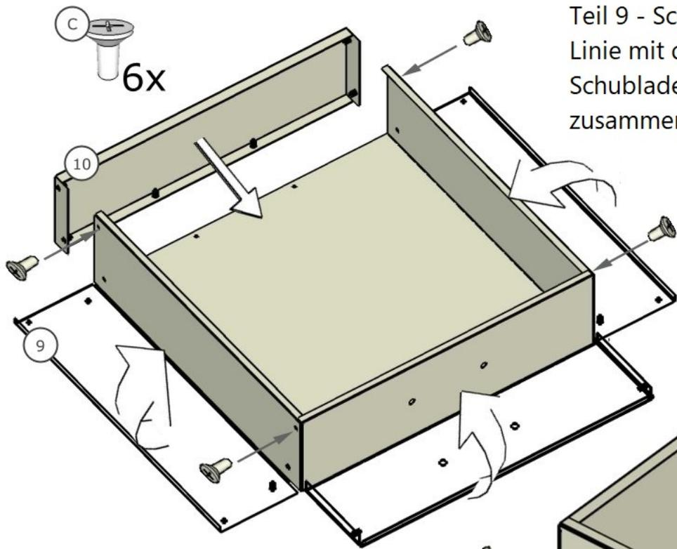
Teil 9 - Schublade: Falten Sie das Stück mit der Hand entlang der perforierten Linie mit den gefalteten Säumen nach innen. Im nächsten Schritt wird die Schublade fertig zusammengebaut. Auf diese Weise werden Sie 2 Schubladen zusammensetzen.
