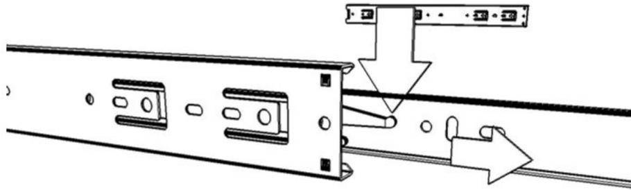
Anordnung der Fahrwerksteile für die weitere Montage
