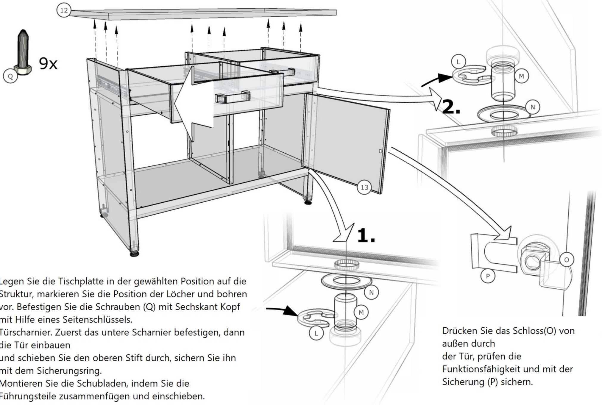
Legen Sie die Tischplatte in der gewählten Position auf die Struktur, markieren Sie die Position der Löcher und bohren Sie vor. Befestigen Sie die Schrauben (Q) mit Sechskant Kopf mit Hilfe eines Seitenschlüssels.
