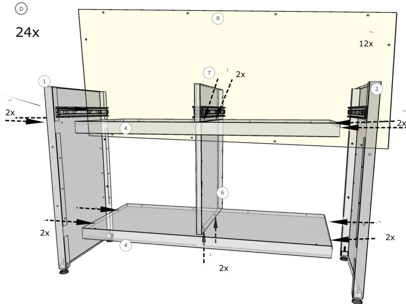
Verbinden Sie zunächst die Schrauben der Teile 1,2 mit den horizontalen Teile 4(2x) einfügen und mit Teilen 6,7 verbinden. Schließlich montieren Sie von der Rückseite aus Teil 8, Schrauben (D)12x.
