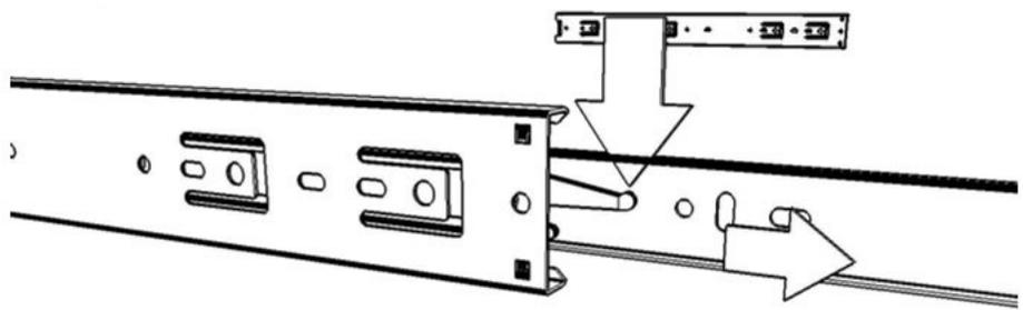
Anordnung der Fahrwerksteile für die weitere Montage
