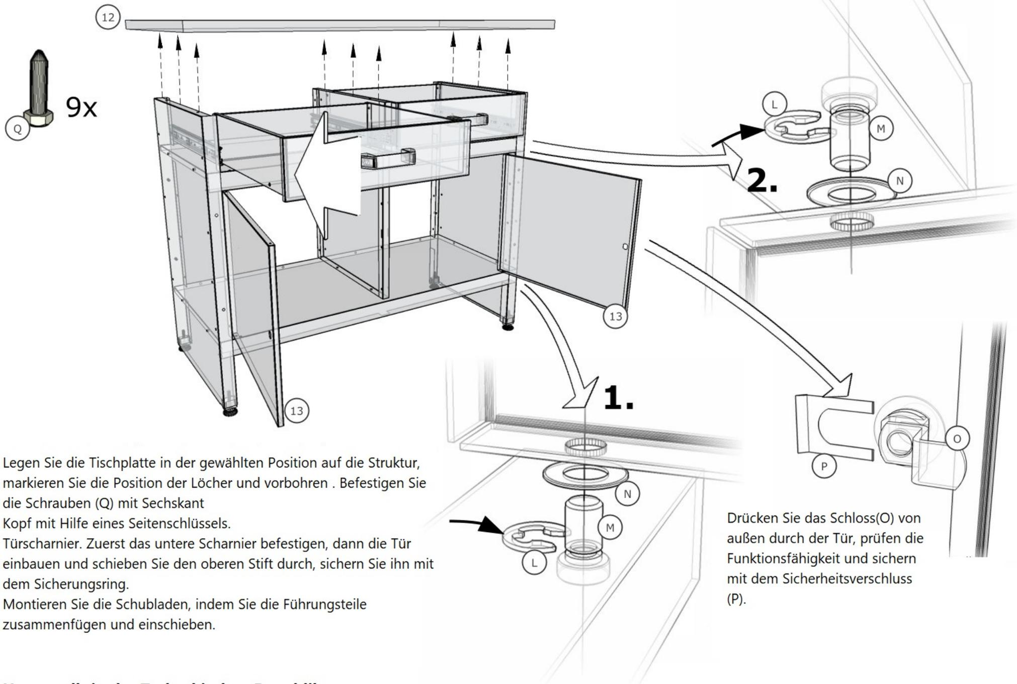
Legen Sie die Tischplatte in der gewählten Position auf die Struktur, markieren Sie die Position der Löcher und vorbohren. Befestigen Sie die Schrauben (Q) mit Sechskant Kopf mit Hilfe eines Seitenschlüssels.
