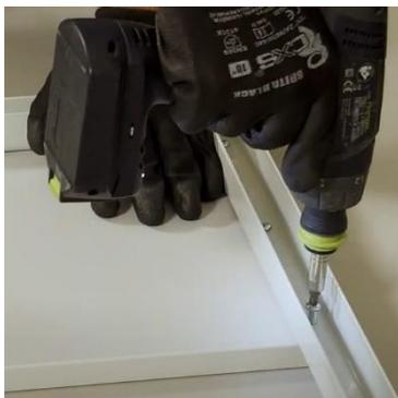
2. Verschraubte Konstruktion befestigen Sie mit dem Schrankkorpus befestigen. Verwenden Sie die Schraube (D) + Unterlage (E) + Mutter (F).
