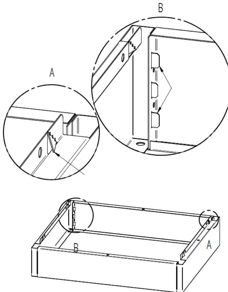
1. Setzen Sie die einzelnen Teile des Sockels zusammen, wie oben abgebildet.
