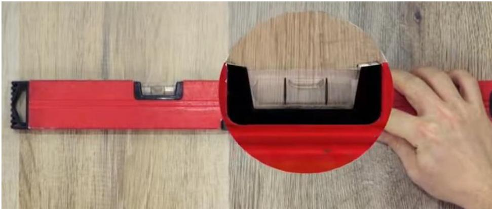
5. Bringen Sie das Piktogramm an der Kante der Wasserwaage an und drücken Sie es dort fest, wo das Klebeband ist.
