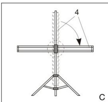
Drehen Sie das Projektionsflächenrohr (4) auf horizontale Position.
