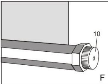
Drehen Sie den Spanner (10) am Ende des Rohrs gegen den Uhrzeigersinn, so um das Projektionstuch richtig zu spannen.
