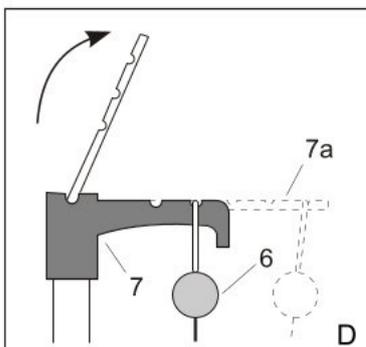
Ziehen Sie die Projektionsfläche (6) aus dem Rohr und fädeln es durch die Öse des Rohrs auf die Haken (7) oder den ausziehbaren Haken (7a).
