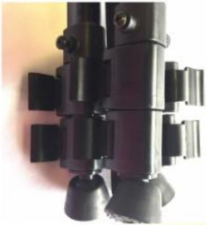
2. Stellen Sie die gewünschte Höhe an allen Beinen ein und sichern Sie sie durch Verriegeln aller Fixierungen. Prüfen Sie, ob die Schrauben, mit denen der Ständer in der gewünschten Höhe befestigt ist, auch ausreichend angezogen sind.
