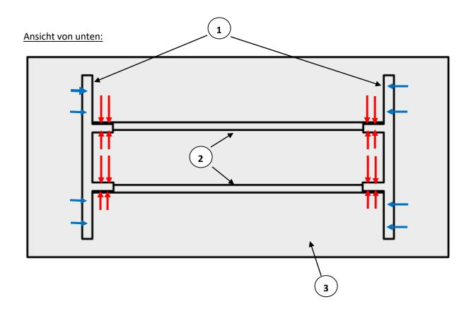
Rote Pfeile zeigen Stellen von verschraubten Metallteilen, die blauen Pfreile zeigen die Stellen der verschraubten Konstruktion mit der Tischplatte.
