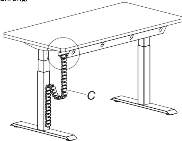
Führen Sie das Kabel in der Kabelführung ein (C).
