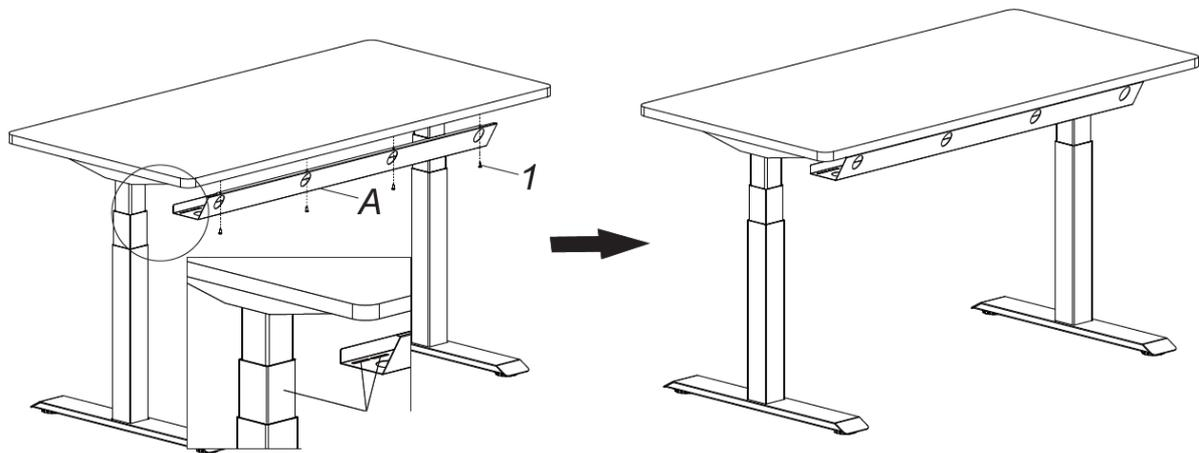
Versichern Sie sich, dass der Kabelhalter auf gleicher Höhe mit dem Pfosten ist.
