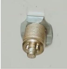
3. Die Lasche auf das Schloss legen und die Mutter einschrauben, dann festziehen. Verriegeln Sie die Tür und prüfen Sie die Funktion des Schlosses.
