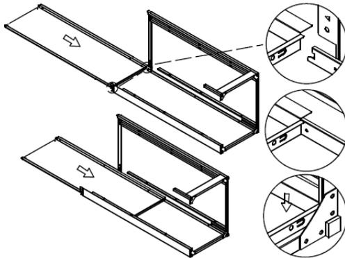
Schieben Sie die Rückwand zwischen die linke und rechte Seitenwand.
