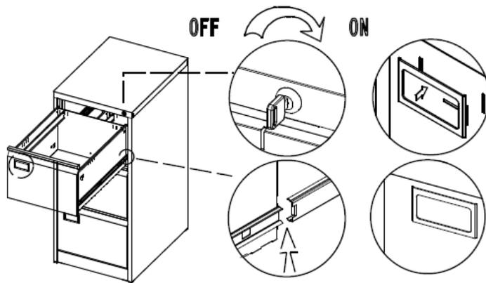
Drehen Sie den Schlüssel, um den Aktenschrank zu verriegeln, setzen Sie die Schublade ein und setzen Sie die Verriegelungswelle des Schlosses oben auf die Schiene. Sobald die Schublade zur Hälfte eingezogen ist, entriegeln Sie den Aktenschrank durch Drehen des Schlüssels. Wenden Sie dieses Verfahren auf alle Schubladen an
