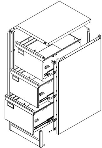
Befestigen Sie den vorderen und hinteren Sockel mit Schrauben an der rechten und linken Seite des Aktenschrankkörpers.
