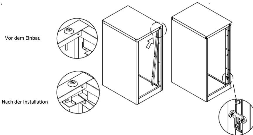
Befestigen Sie die Sperrstange mit dem Verbindungsstück wie in der Abbildung gezeigt.
