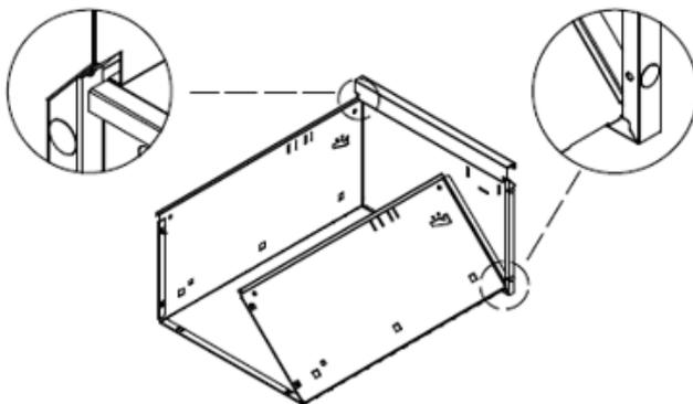
Die Buchsenstruktur aufklappen und mit der Frontplatte verbinden.
