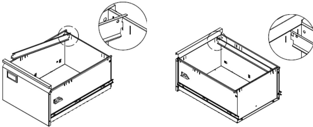
Befestigen Sie die Aufhängeschienen (1x Schiene/Socket).
