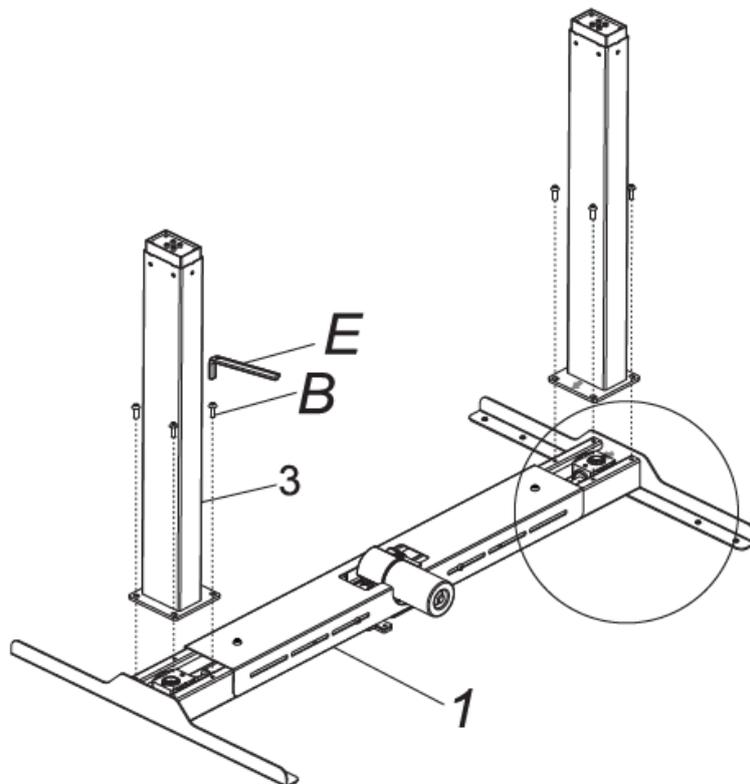
Bei der Montage ist zu beachten, dass der Pfeil auf der Hebesäule in Richtung Motor zeigt. Danach den Sechskantkopf der Hebesäule längs der Führungsnut des Trägers einfügen.
