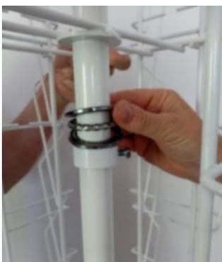
← Zusammensetzung des Sicherungsringes und des Lagers
