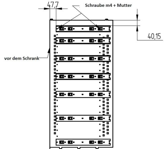
**ACHTUNG** - Die Position der Schubladen unterscheidet sich je nach gewählter Konfiguration der Schubladen !!!!
